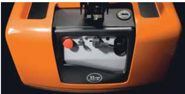
Кнопка экстренного выключения и провод зарядного устройства легко доступны для оператора.
