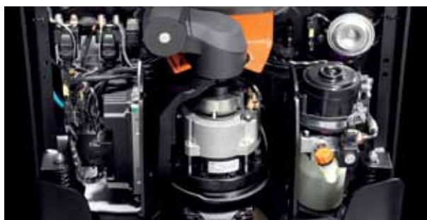
Двигатель жестко закреплен, в нем нет подвижных кабелей.
