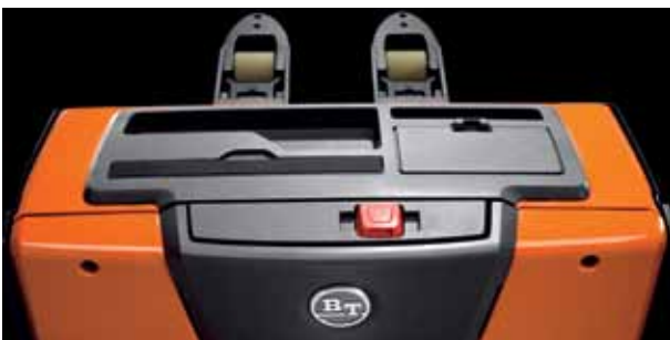
Концы вилок отлично видны с места оператора. Это повышает безопасность и упрощает работу.
