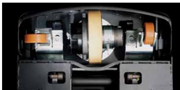
Для оптимальной устойчивости и управляемости модель LWE130 оборудована шасси с пятью точками опоры. Самоориентирующиеся колеса шасси при повороте не выходят за внешние контуры корпуса.
