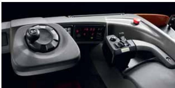
360° рулевое управление обеспечивает максимальную маневренность и управление с приложением минимальных усилий
