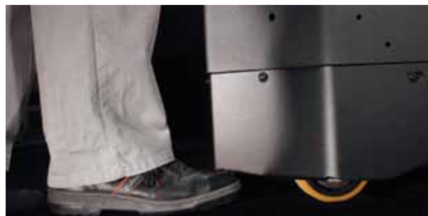
Низкое расположение и форма бампера на моделях серии P защищает ноги оператора, не ухудшая возможность движения по рампам и наклонным поверхностям.
