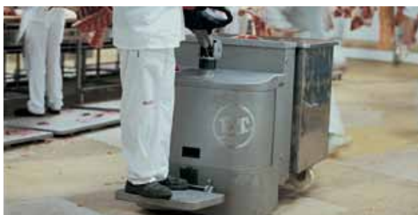
Применение нержавеющей стали при изготовлении модели LPE200I обеспечивает длительный срок службы в коррозионной среде.
