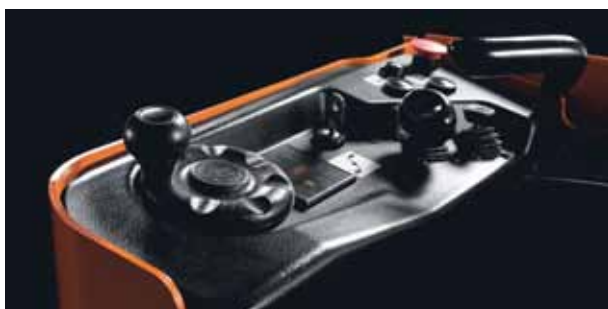
Поворачивающийся на 180° руль упрощает управление движением LSE200
