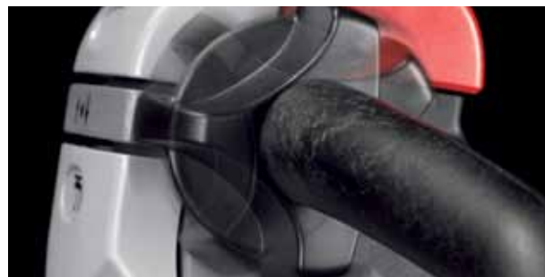
Функция Click-2-Creep позволяет маневрировать с поднятой вертикально рукояткой управления.
